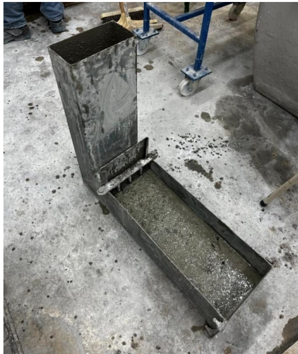
Figure 3.18 - L-Box Test Setup (BS EN 12350-10:2010, 2010).
