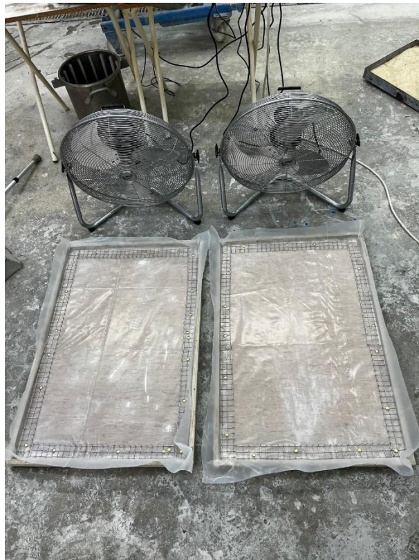
Figure 3.38 - Kraai Test Setup (Kraai, 1985).
