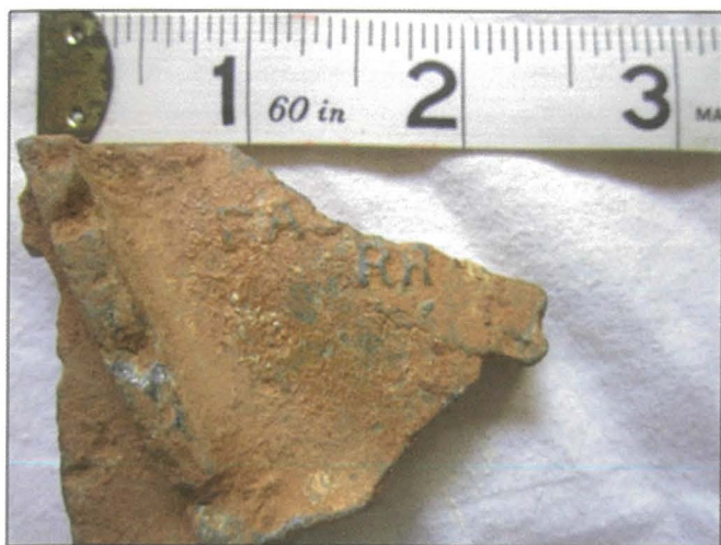
Fig 4 : Parti mill-casing tal-magna li turu il-kliem RR – Rolls-Royce.
