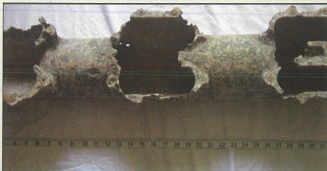
Fig 2 : L-intake manifold tal-magna Merlin li Ġużepp Vella (Tas-Snakes) kien refa' forsi xi darba jiġi bżonnha.
