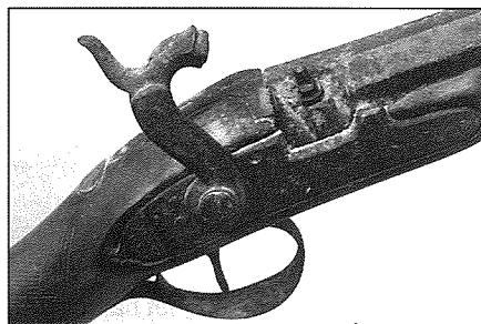
Fig. 3. Il-mekkanizmu ta' l-ixkubetta tal-grillu bil-kapsa. (i.e. Percussion Cap Musket ) ġ E. Bonanno.
