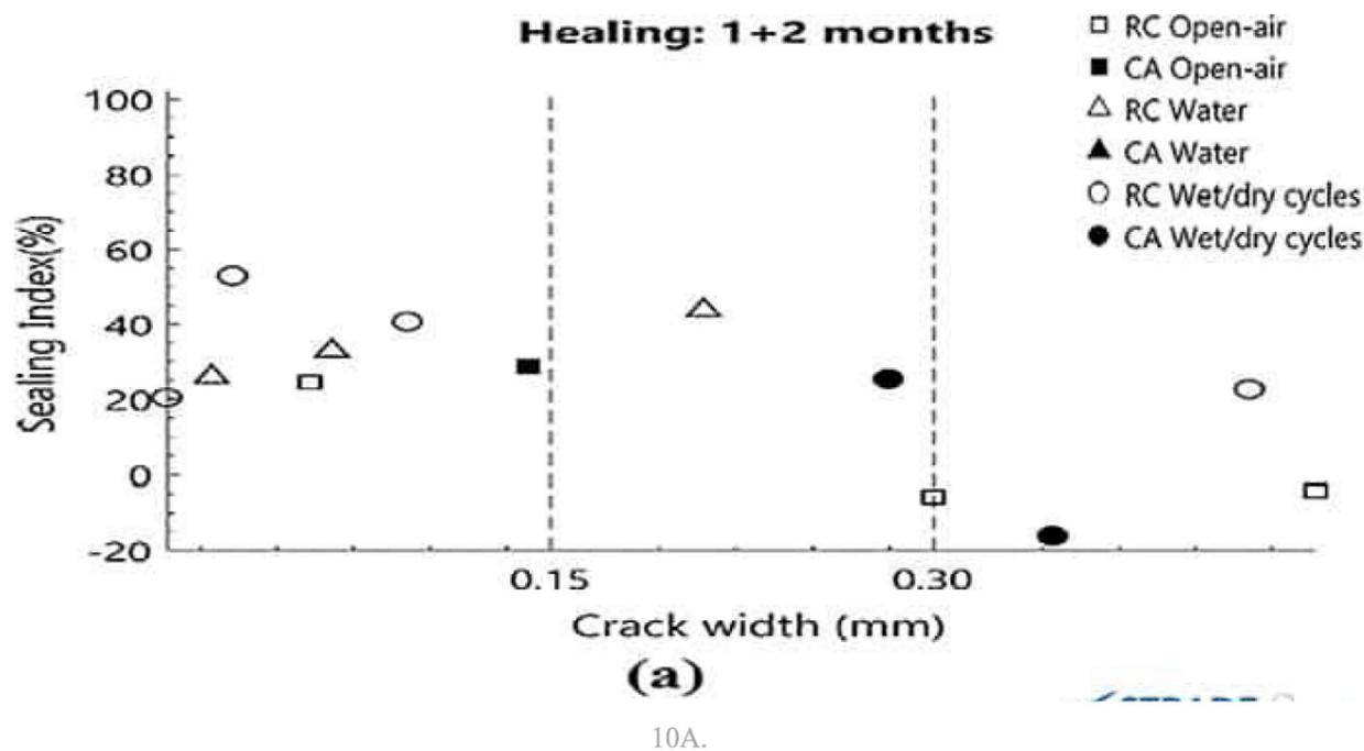
Il rapporto acqua/polvere (A/P) è sempre stato mantenuto costante a 0,55; il cemento utilizzato è CEM II 42.5 R. Sono stati prodotti dei campioni cilindrici che, dopo un periodo di cura di 21 giorni, sono stati pre-fessurati a trazione e poi sono stati esposti a sei diversi ambienti per un periodo di 84 giorni:
